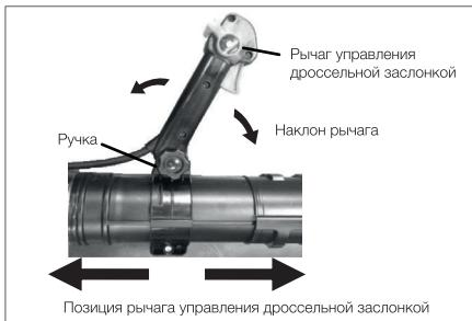
Когда ранцевая воздуходувка находится на спине у оператора, рычаг подачи воздуха должен быть закреплен на трубе.
