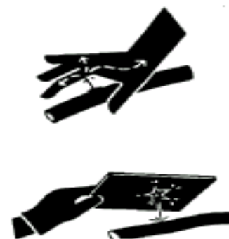
Рис. 1-9. Утечка из гидравлического трубопровода
