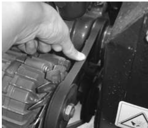
Рис. 5-21 Регулирование натяжения резиновой ленты вентилятора
